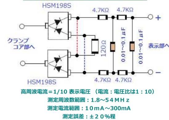
高周波電流 = 1/10 表示電圧 (電流 : 電圧比は1 : 10)
