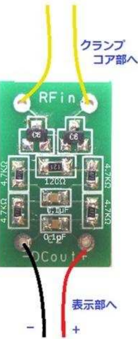
検波部基板を取手に内蔵配置した 製作例
