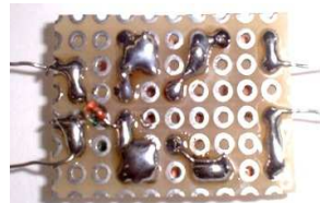
基板半田面に ダイオード1本配置
