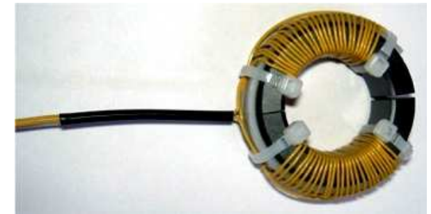
電流トランスの製作 完成例 ナイロンクランプの上から50回巻、 開閉口のナイロンの突起部分はカットしました
