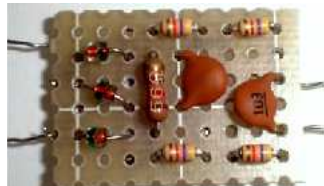
検波部基板を取手に内蔵配置した 製作例
