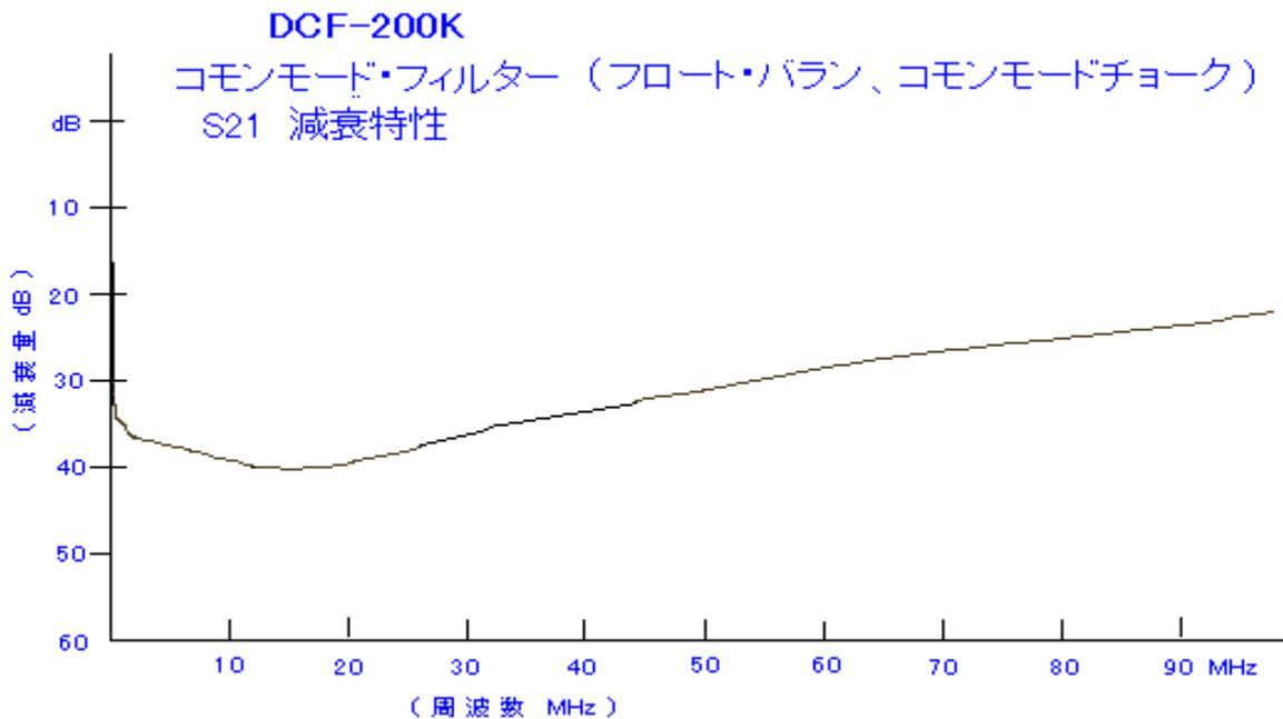
テレビジョン等と、フィルターまでの同軸ケーブルが長いとフィルターの効果が半減します、出来るだけテレビジョン等のアンテナ入力端子に直接取り付けて下さい
