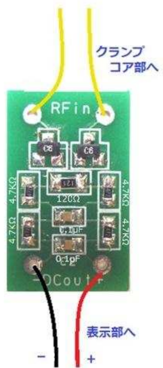
検波部基板を取手に内蔵配置した 製作例
