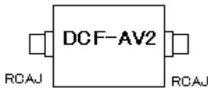
VTR,TV,オーディオアンプなどからフィルターまでのコードが長いとフィルターの効果が半減します、出来るだけ機器の入力端子に接続して下さい。
