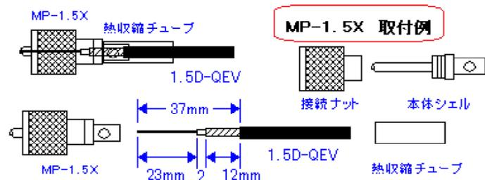
注: 高熱に弱いので 接続ナットを付けた状態で半田付けします
